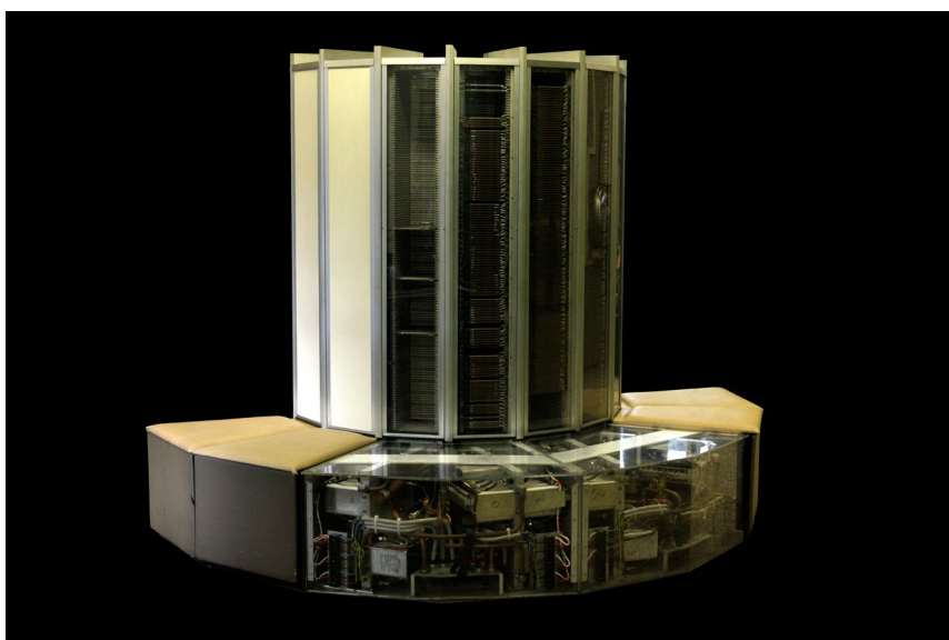
Cray-1 vuodelta 1976. Koneen erikoisen muotoilun lähtökohtana ei ole estetiikka vaan komponenttien välimatkojen ja lämmönvaihdon optimointi.
